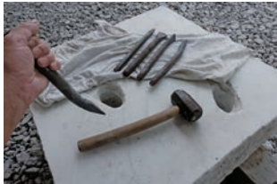
図12 基台の加工。大理石への穴あ けとその道具の再現
