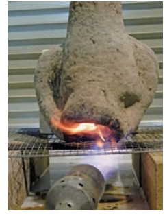
図84 鑄型脱蠟焼成実験。〈戦士像B〉左腕肘先とポルパークスの再現品
