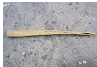
図46 中子土貼り込用に考案した長手の木製笥（長さ約40cm）
