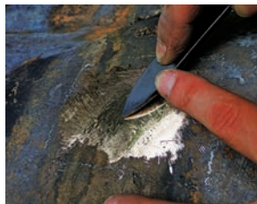
図12 キサゲによるブロンズ削り出し。《戦士像A》右足の再現品
