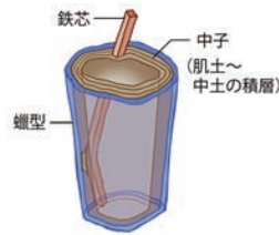
図41 蠟型の内側に、中子土を積層する（筒状略図）
