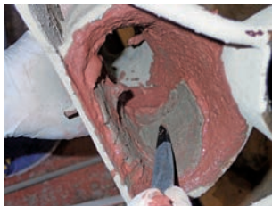
図42 水牛の角を使った、中子土の積層。《戦士像B》左腕肘先とボルパークスの再現品
