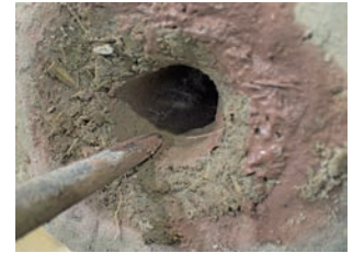
図45 中子中心部の粗土の挿入。《戦士像B》左腕の再現品
