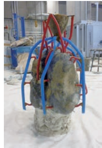
図⑦ 現代の蠟型石膏鑄造の湯道構造 (筆者作品)
