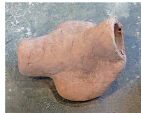
図85 本焼成を終えた鑄型。〈戦士像B〉左腕肘先、ポルパークスの鑄型再現品
