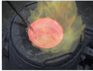
図98 坩堝での金属溶解（現代の 炉）実験ではCu78:Sn12を 更合わせて、再現像に使用 した。
