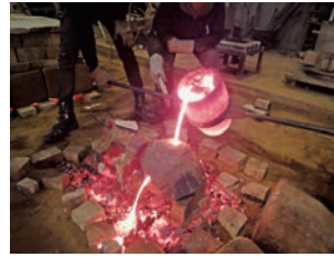
図104 鑄掛熔接実験.《戦士像A》左肩の再現品
