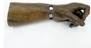
図59 リアーチェのブロンズ《戦士像B》左腕肘から先の蠟型。連続楕円形溶接のための溝開け(再現品)
