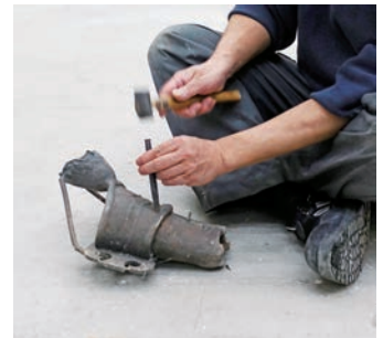
図96 鑄込み後の《戦士像B》左腕肘 先とボルパークスの再現品、鑿 での補修作業
