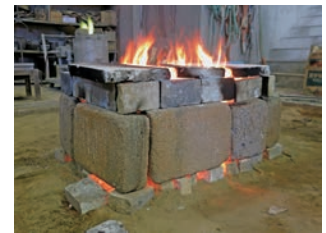
図86 路地窯での焼成実験 薪を燃やし、約800℃に上げる（本焼成）
