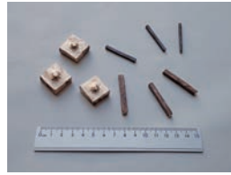
図68 再現制作したブロンズ変形型持 (左: 20 mm 角) 鉄筭 (右上: 一辺 2 mm の四角柱)・ブロンズ筭 (右下: 一辺 5 mm の四角柱)
