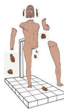
図19 蠟油土塑造原形の分解。《戦士像A》直接法部分の切り取り。濃い色の部分は、直説法としてそのまま蠟型となる(髪の毛は概略で、実際は数十パーツとなる)。
