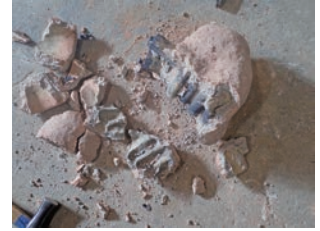
図94 鑄型の解体。《戦士像B》左 手の再現品
