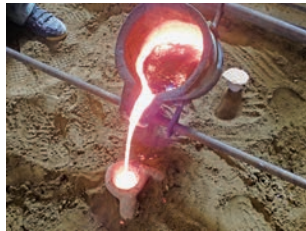
図92 鑄込み実験。《戦士像B》左 腕肘先とボルパークスの再現 品
