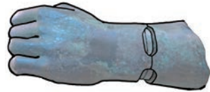
図98 連続楕円形鑄掛熔接の前加工.《戦士像A》左手首
