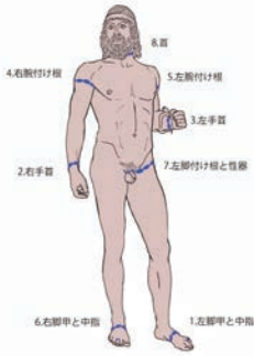
図97 分鑄部品を熔接する.《戦士像A》溶接箇所とおおよその順序
