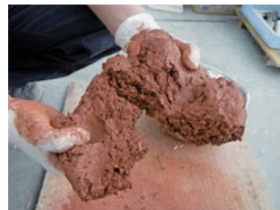
図43 中子土の再現。陶土、石灰、砂、再生シャモット、牧草、動物の毛、水など
