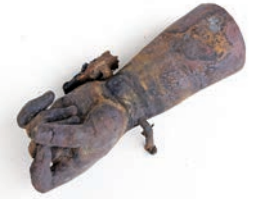
図105 鑄掛熔接を終えた部品.《戦士像B》左腕肘から先の再現品(ポルパークスは省略)
