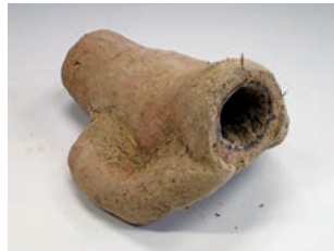
図78 積層を終え、乾燥させた鑄型。〈戦士像B〉左腕肘先とポルパークスの再現品
