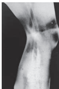
図50 リアーチェのブロンズ《戦士像A》右脚のX線写真(横筋). 出典: Riace 2002, II, p. 185, fig. 386
