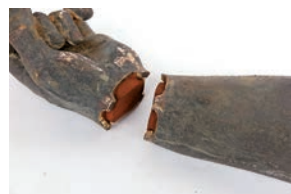
図101 鑄掛熔接の準備段階.《戦士像B》左手の再現品
