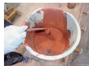
図39 肌土／埴汁の再現。陶土、馬糞または牛糞、水の配合物
