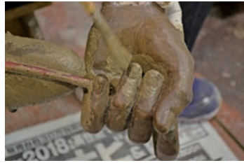
図76 鑄型の制作～馬糞入り肌土スラリーの塗布。〈戦士像B〉左手の再現品
