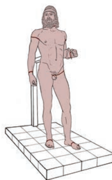
図18 《戦士像A》の分鑄箇所。分解するラインを形式に沿って決める。
