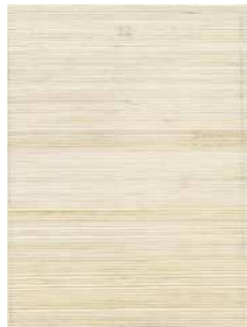
No. 18, 23, 24 経糸: 絹糸 緯糸: バナナ 績み糸 warp: silk yarn weft: banana hand-knotted yarn
