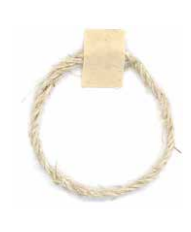
No. 14 バナナ50%×ラミー50% 混紡糸 50/50 banana/ramie blended yarn
