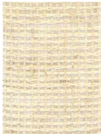
経糸: バナナ50%×綿50% 混紡糸 緯糸: バナナ50%×ラミー50% 混紡糸 warp: 50/50 banana/cotton blended yarn weft: 50/50 banana/ramie blended yarn
