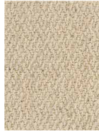
経糸, 緯糸: バナナ50%×綿50% 混紡糸 加工: アルカリ精練 warp, weft: 50/50 banana/cotton blended yarn alkali scouring process
