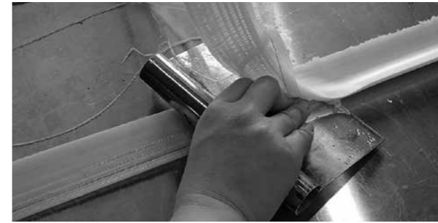
図 | Fig.8 外側と内側を分ける Dividing outer and inner skin of banana pseudostems
