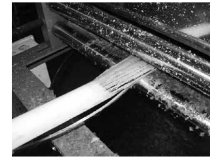
図 | Fig.11 機械による繊維抽出 Banana fiber extraction using machine
