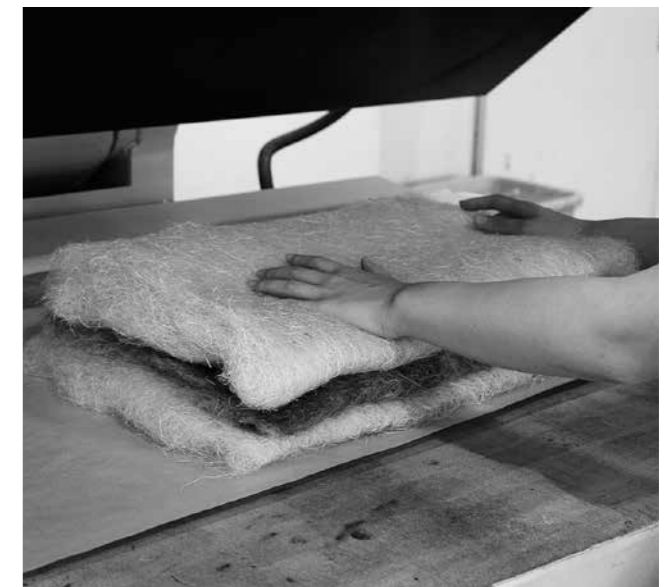
図 | Fig.31 シートをプレス機に挿入する Inserting the sheet into the pressing machine
