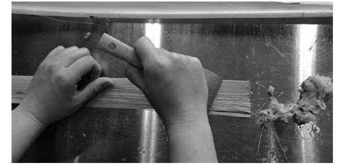
図 | Fig.9 不純物を取る Extracting banana fibers and remove impurities
