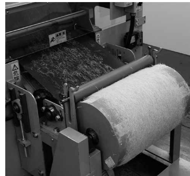
図 | Fig.30 開繊カード機によるシート作成 Making a sheet by opening and carding machine
